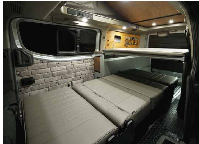
ベッド展開時 1920mm×900mm 2段ベッド(就寝時収納スペース) 1800mm×1190mm
