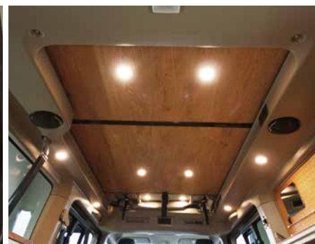
板目天井+LED照明
